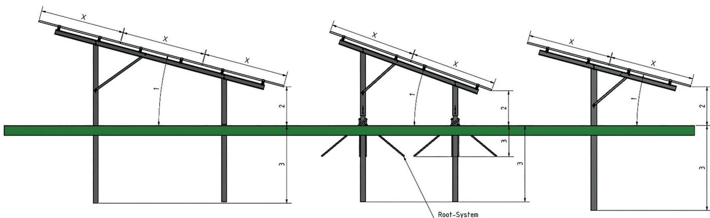
Alle 2-Pfostensysteme können als Root-System ausgeführt werden
